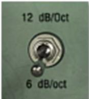
Режим **6 dB/oct** обеспечивает плавное колено, что делает его идеальным для гладких срезов.
